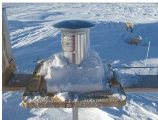
Accumulo di neve attorno alla testa di misura dell'OPC dopo una giornata di forte vento.
