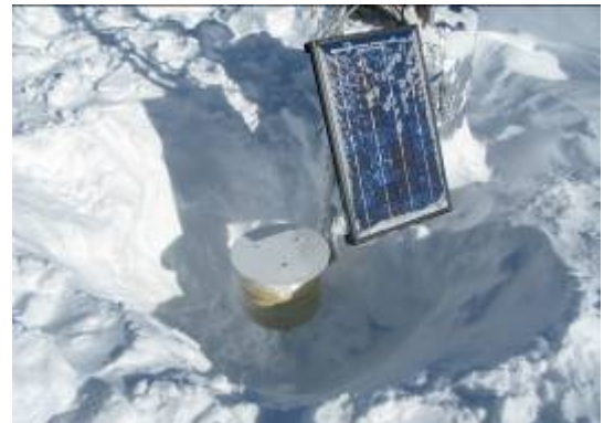
Sensore del primo livello della Torre Argentini, completamente al di sotto della superficie.
