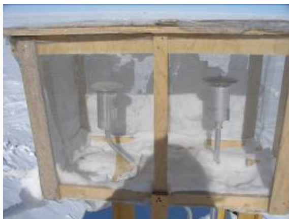
Teste di misura del campionatore FAI HYDRA sul tetto dello shelter GLACIO
