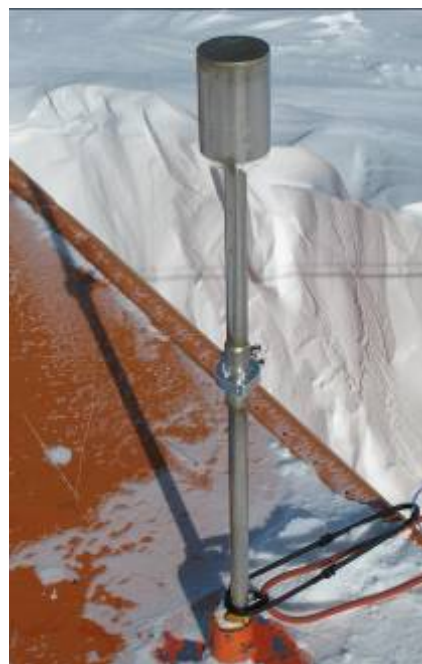
Inlet sul tetto per DMPS, GRIMM e PSAP.
