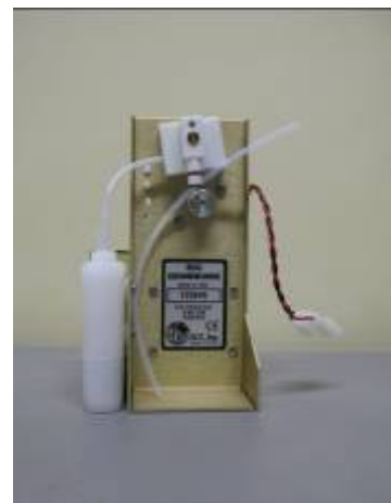
Sonda Ozono ECC per l'esecuzione dell'ozono sondaggio.
