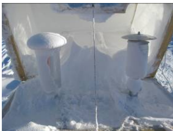
Neve accumulata attorno alle due teste di misura PM 10 del TECORA giornaliero.
