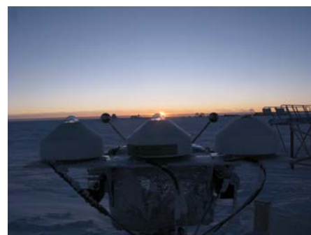
Solar Tracker della BSRN con i piranometri.
