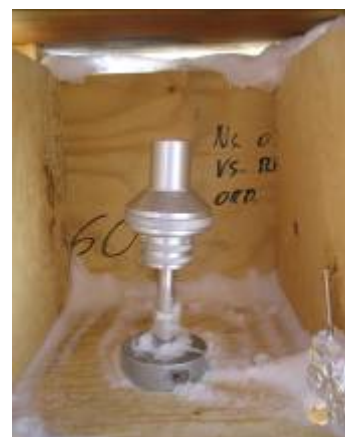
Testa di misura del campionatore TECORA per la determinazione del carbonio
