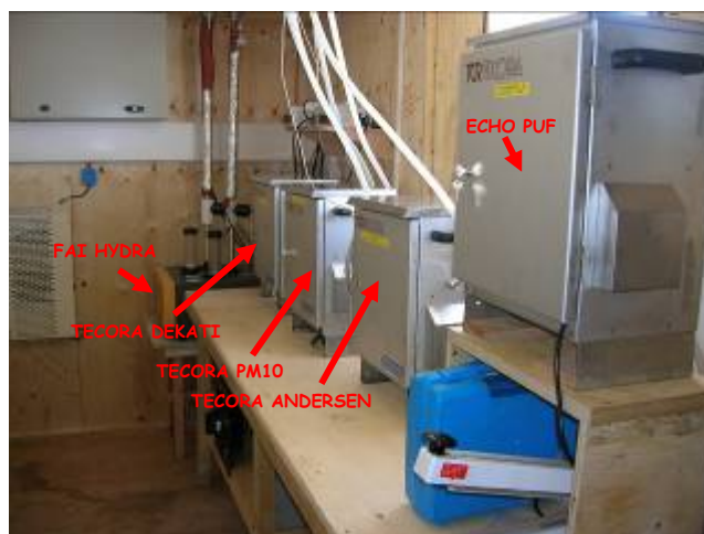
Interno dello shelter GLACIO, lato destro, con i campionatori di aerosol
