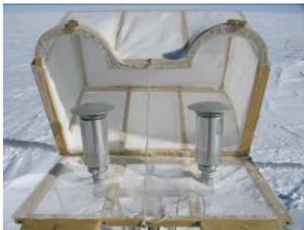
Testa di misura del campionatore a due vie
