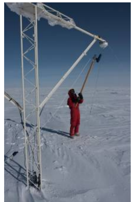
Pulizia con pistola termica del Tracker dell'albedo.
