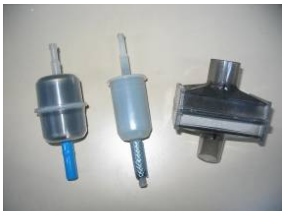
Filtri dell'aria usati per le pompe.
