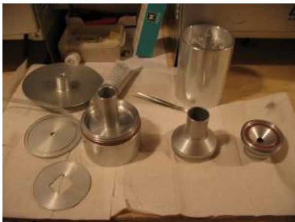
Testa PM 10 smontata per la pulizia.
